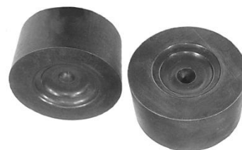
Рис. 12. Заготовки порожнин матриць зі сталі Р6М5, які отримані видавлюванням
