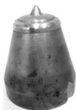
Рис. 11. Деформуючий пуансон для видавлювання порожнин
